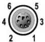
Ilustración B-3. Números de patas del conector para ratón y teclado compatible con PS/2
